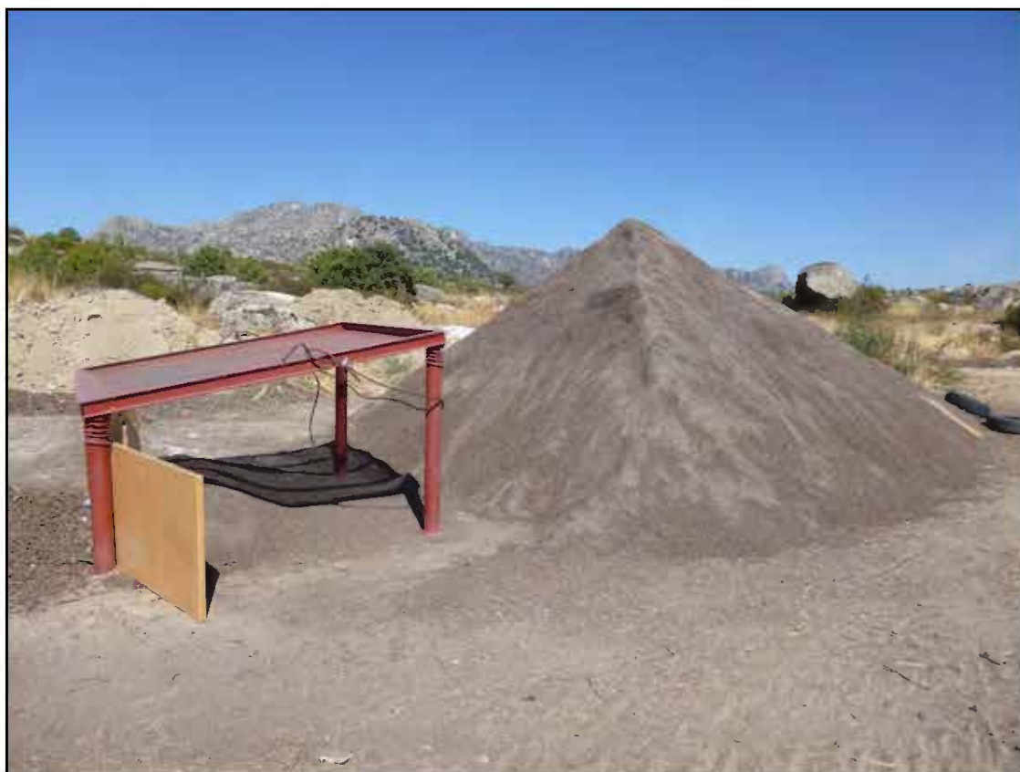
Imagen 2. Zona de cribado, control de calidad y ensacado. Izquierda: Cribadora.
